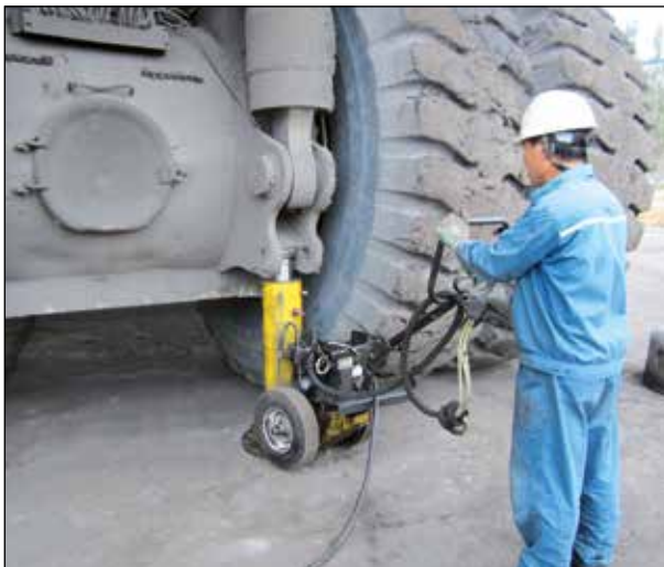
◀ Podnośnik Enerpac POW'R-RISER® używany do podnoszenia ciężkiego sprzętu.
